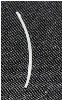
图2 生物可降解材料 PLLA:PCL 6:4+15% PEG 泪道支架外观
