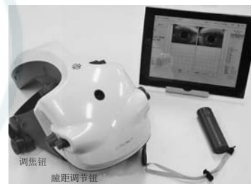
图 2 Imo 头戴式视野计 [8] 包括视野检测头盔、控制平台及应答按钮
