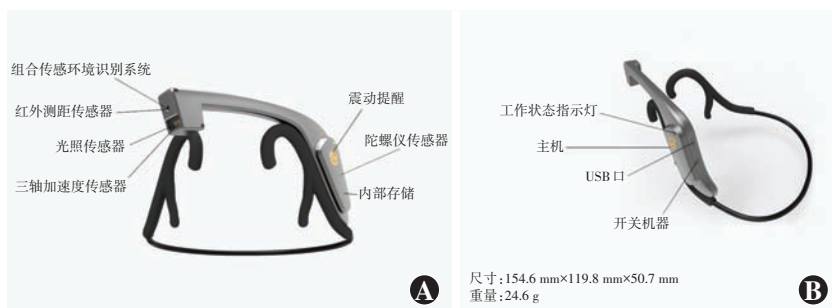
图 1 Eye-Monitor 功能模块示意图 A: 传感器分布图 B: Eye-Monitor 基本参数示意图 Figure 1 Function module diagram of Eye-Monitor A: Diagram of sensors distribution B: Diagram of basic parameters of Eye-Monitor
