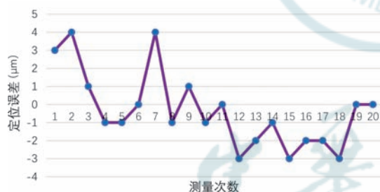
图 8 重复定位误差 测量次数为在同一目标位置下进行测量
